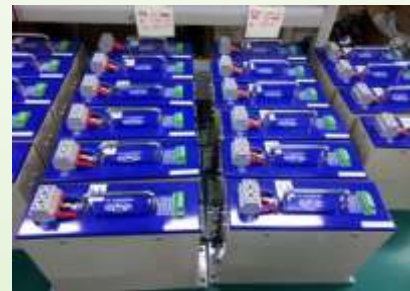
模块尺寸, 长 305mm x 宽 115mm x 高 263mm
